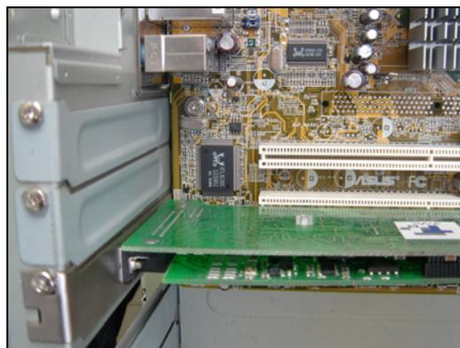
рис. 6.2 Установленная плата DragNet
